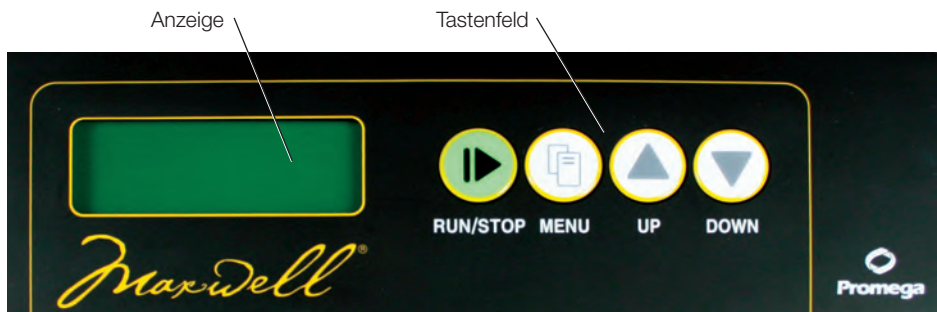
Abbildung 2. Maxwell® 16 Instrument – Anzeige. Die LCD-Anzeige und das Tastenfeld mit den Tasten Run/Stop, Menu, Pfeil nach oben und Pfeil nach unten.
