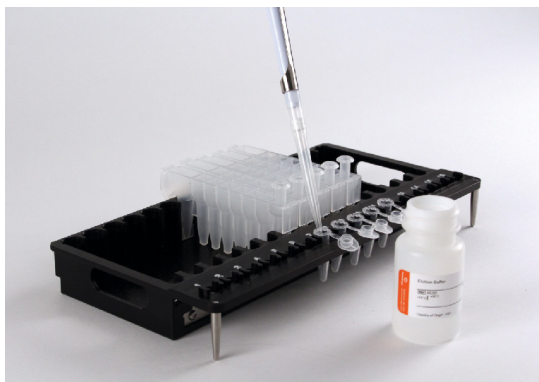
Abbildung 2. Einrichtung und Konfiguration der Kartuschenhalterung. In die Elutions-Gefäße wird, wie angegeben, Elutions-Pufferlösung gegeben.
