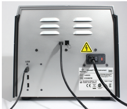
Abbildung 12. Anschließen des Tablet-PCs an der Rückseite des Maxwell® CSC Instrument.
