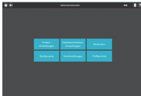
Abbildung 26. Maxwell® CSC-Bildschirm „Administratorseite“. Der Bildschirm „Administratorseite“ bietet Zugriff zum benutzerdefinierten Anpassen des Verhaltens verschiedener Aspekte des Maxwell®-CSC-Systems.
