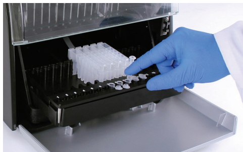
Abbildung 48. Schließen der Elutions-Gefäß-Kappen.
