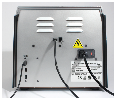
Abbildung 3. Rückansicht des Maxwell® CSC Instrument. Auf der Rückseite des Geräts befindet sich der Netzschalter, der Netzkabelanschluss, der USB-Anschluss für die Verbindung zwischen Gerät und Tablet sowie drei weitere USB-Anschlüsse für Peripheriegeräte (z. B. Barcode-Leser).
