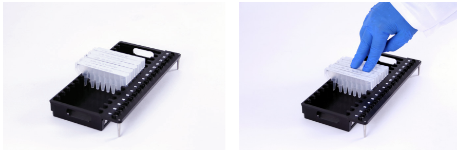
Abbildung 43. Die Kartuschen in der Kartuschenhalterung platzieren und fest nach unten drücken, damit sie einrasten.
