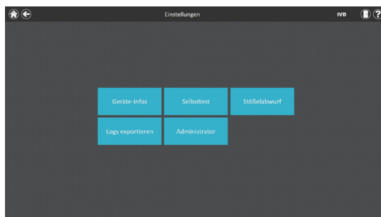
Abbildung 17. Maxwell® CSC-Bildschirm „Einstellungen“. Über diesen Bildschirm kann auf verschiedene gerätespezifische Funktionen zugegriffen werden. Die Administrator -Schaltfläche wird nur bei Windows®-Benutzerkonten mit Zugang zur Maxwell® CSC-Software auf Administratorebene angezeigt.
