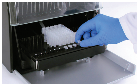
Abbildung 49. Entnehmen der Elutions-Gefäße und der Kartuschenhalterung.
