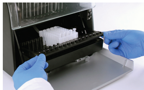
Abbildung 49. Entnehmen der Elutions-Gefäße und der Kartuschenhalterung.
