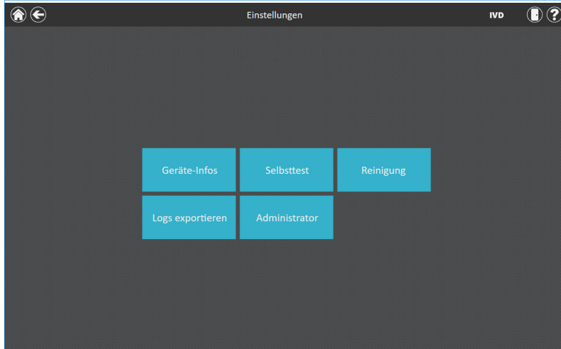
Abbildung 26. Bildschirm „Einstellungen“ (Settings) der Maxwell® CSC-Software. In Windows®-Benutzerkonten, die der PromegaAdministrators-Gruppe hinzugefügt wurden, wird die Schaltfläche Administrator auf dem Bildschirm „Einstellungen“ (Settings) der Maxwell® CSC-Software angezeigt.
