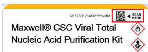
Abbildung 34. Kit-Etikett und zu scannender Barcode. Um einen Aufreinigungslauf zu starten, scannen Sie den Barcode, der durch die rote Umrandung gekennzeichnet ist.
