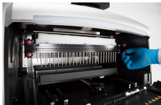
Abbildung 7. Entfernen der beiden Schaumstoffstücke aus dem Inneren des Geräts. Bild A. Entfernen Sie die vorn liegenden Schaumstoffstücke. Bild B. Entfernen Sie die vier Transportsicherungsschrauben von den Seiten des vorderen Magnetstabs und der Stößelhalterung.
