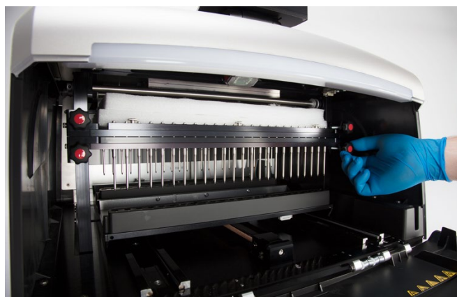
Abbildung 63. Platzieren der Kunststoffstopper. Magnetstab und Stößelhalterung nach oben bewegen und die vier Transportsicherungsschrauben an beiden Seiten des Magnetstabs und der Stößelhalterung sichern.
