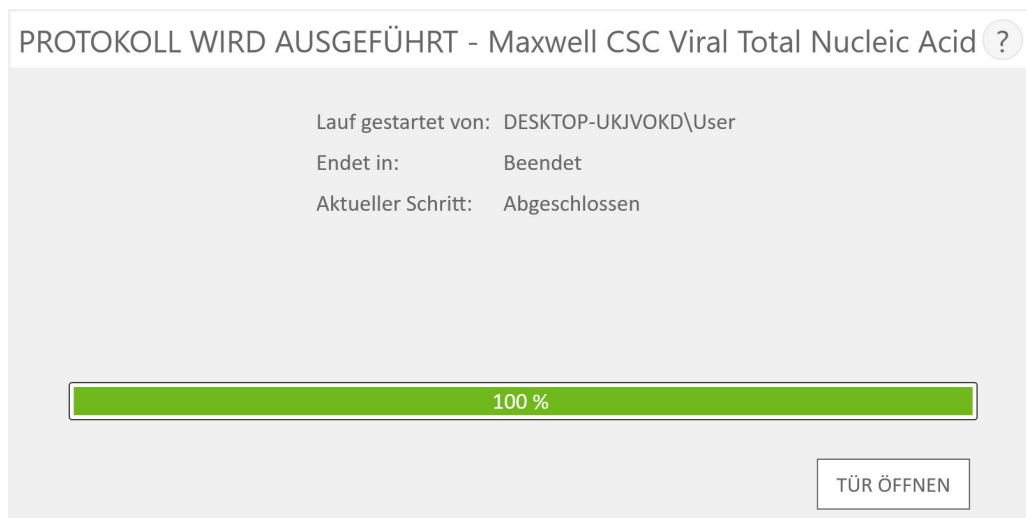
Abbildung 44. Bildschirm „Protokoll wird ausgeführt“ nach Abschluss des Methodenlaufs. Nach Abschluss des aktuell ausgeführten Extraktionsmethodenlaufs zeigt die Fortschrittsleiste 100 % an. Der aktuelle Schritt ändert seine Anzeige auf Abgeschlossen, nachdem ein Durchlauf fertig ist. Nachdem ein Methodenlauf abgeschlossen wurde, können Sie auf die Schaltfläche Tür öffnen tippen, um die Tür des Maxwell® CSC 48 Instrument zu öffnen und die Kartuschenhalterungen zu entnehmen.
