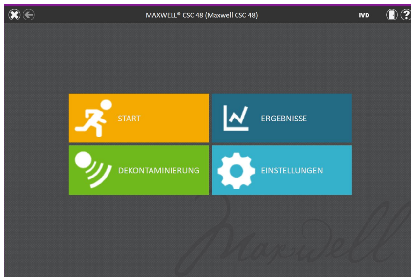
Abbildung 54. Maxwell® CSC 48 Startbildschirm. Durch Auswahl von Ergebnisse wird der Maxwell® CSC 48 Bildschirm „Ergebnisse“ geöffnet, über den Sie Extraktionsberichte zu allen Methodenläufen anzeigen können.
