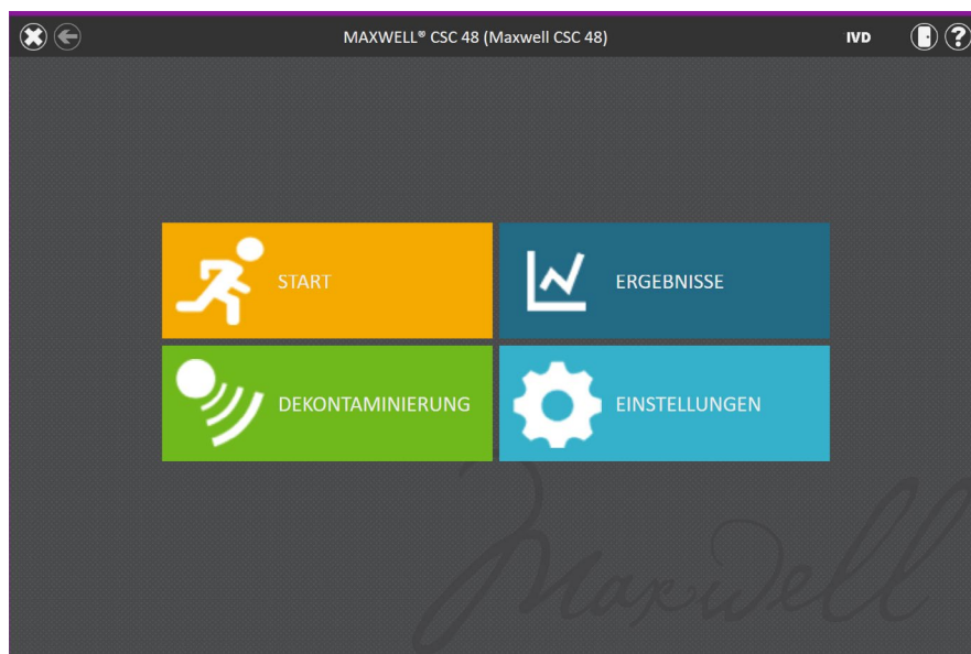
Abbildung 32. Maxwell® CSC 48 Startbildschirm. Durch Auswahl der Schaltfläche Start wird der Extraktionsmethodenlauf auf dem Maxwell® CSC 48 Instrument gestartet.
