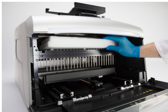
Abbildung 8. Entfernen des oberen Schaumstoffstücks vom Gerät. Schieben Sie den Magnetstab und die Stößelhalterung nach unten, um das oben liegende Schaumstoffstück zu entfernen.
