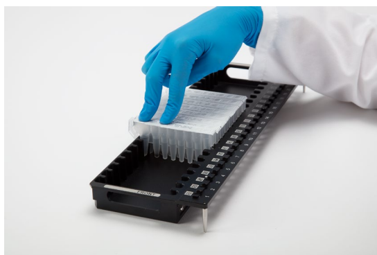
Abbildung 40. Die Kartuschen werden in der Kartuschenhalterung platziert und fest nach unten gedrückt, damit sie einrasten.
