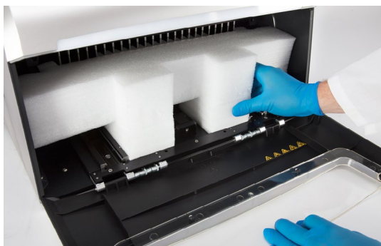
Abbildung 7. Entfernen der beiden Schaumstoffstücke aus dem Inneren des Geräts. Bild A. Entfernen Sie die vorn liegenden Schaumstoffstücke. Bild B. Entfernen Sie die vier Transportsicherungsschrauben von den Seiten des vorderen Magnetstabs und der Stößelhalterung.
