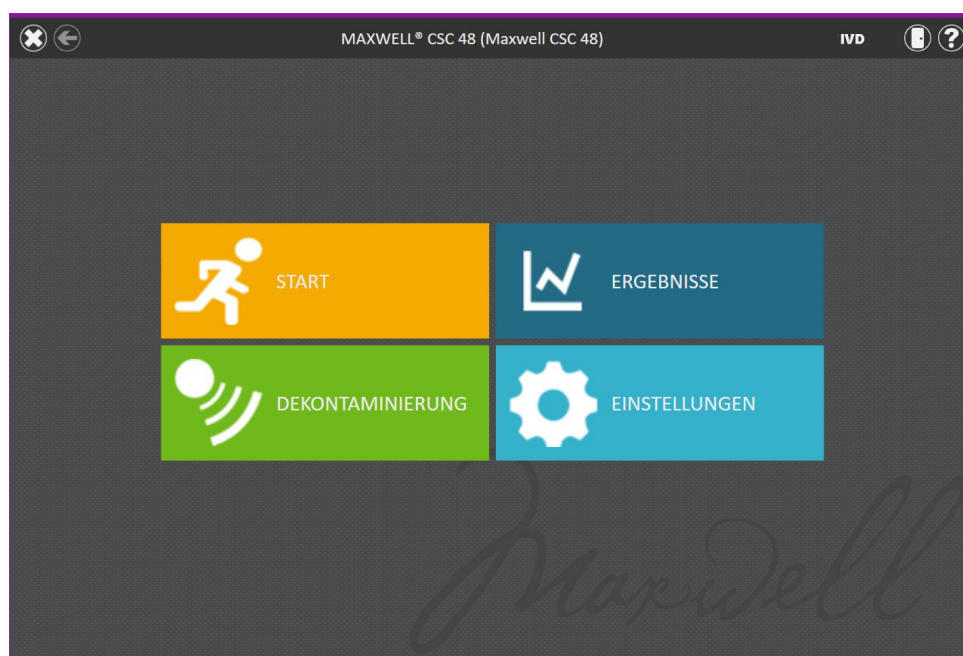
Abbildung 57. Startbildschirm. Wenn Sie die Schaltfläche Dekontaminierung auswählen, wird die UV-Behandlung des Maxwell® CSC 48 Instrument gestartet.
