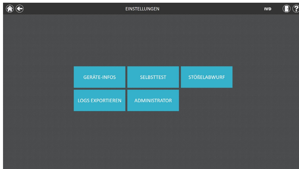
Abbildung 14. Maxwell® CSC 48 Bildschirm „Einstellungen“. Über diesen Bildschirm kann auf verschiedene gerätespezifische Funktionen zugegriffen werden. Die Administrator -Schaltfläche wird nur bei Windows®-Benutzerkonten mit Zugang zur Maxwell® CSC 48 Software auf Administratorebene angezeigt.
