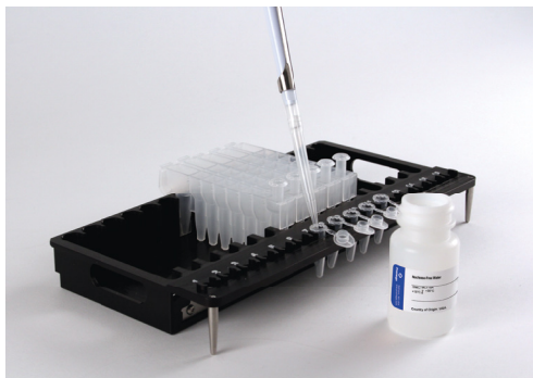
Abbildung 1. Einrichtung und Konfiguration der Kartuschenhalterung. In die Elution Tubes wird, wie angegeben, Nuclease-Free Water gegeben. Öffnen Sie die Elution Tubes vor Beginn einer Extraktionsmethode.
