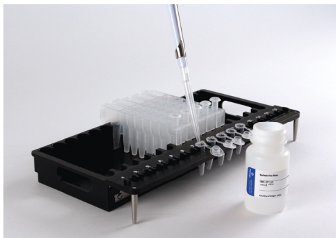
Abbildung 7. Einrichtung und Konfiguration der Kartuschenhalterung. In die Elution Tubes wird, wie angegeben, Nuclease-Free Water gegeben. Öffnen Sie die Elution Tubes vor Beginn der Extraktionsmethode.
